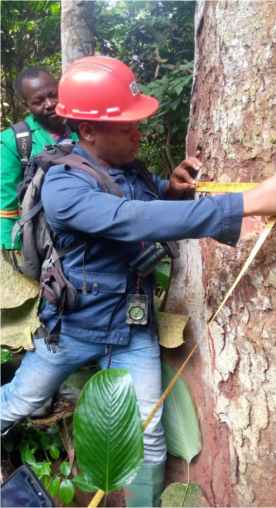
Figure 7: Mesure du Diamètre de l'arbre
